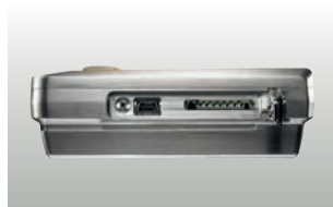
Seitlicher Anschluss von Mini-USB-Kabel und SD-Karte
